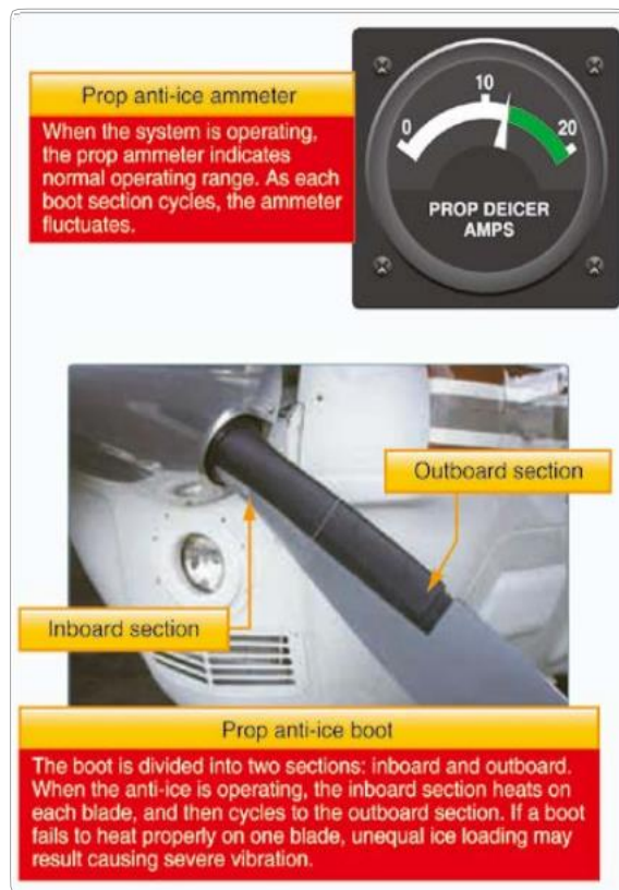
[그림 2-83] Propeller anti ice boot system
