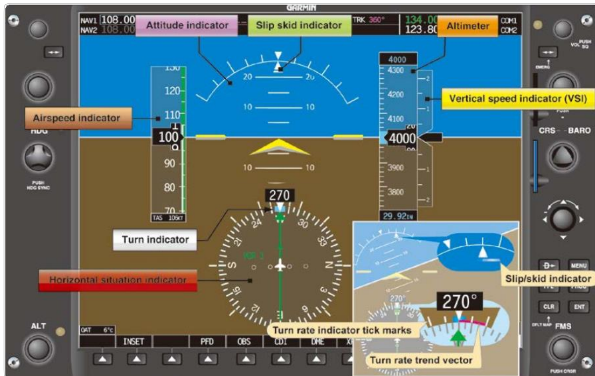
[그림 2-150] G1000 PFD의 각종 표시
