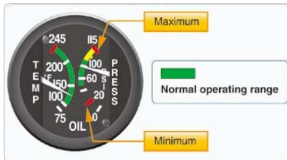
[그림 3-17] 엔진작동의 제한 표시
