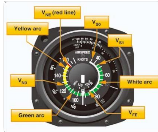
[그림 4-17] 속도계의 색 표시
