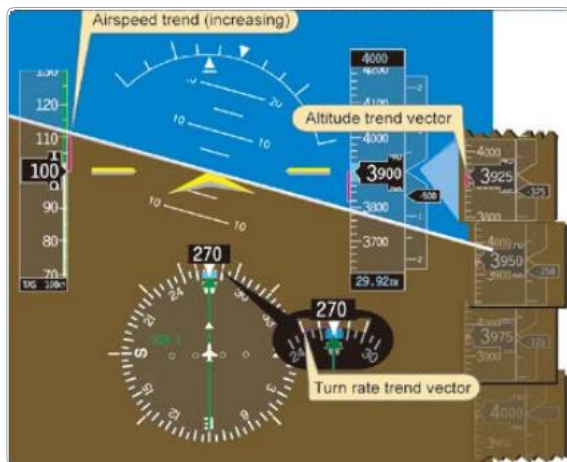
[그림 2-152] Altimeter trend vector
